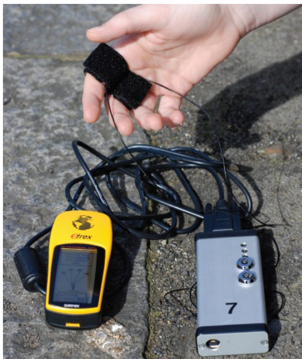
Obr. 3.13: Zařízení pro biomapping Christiana Nolda sestává z GPS lokátoru, snímače odporu kůže připevněného k prstům a záznamníku.
